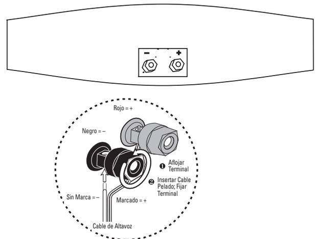
Figura 5. Los altavoces satélite y del canal central presentan terminales que podrán ser conectadas de distinto modos (p.e., a través de conector o cableados directamente, tal como le muestra la imagen).
